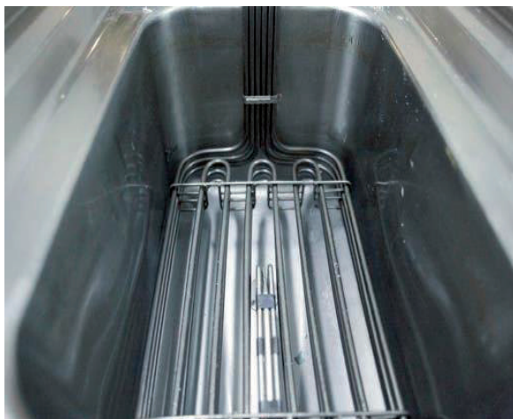
Abb. 6: Lage von Temperaturregler und STB zwischen den Heizspiralen
