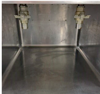
Abb. 7 und 8 Fritteuse mit verdeckter Anbringung der Fettablassvorrichtung
